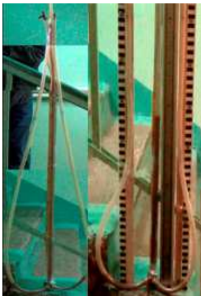
Рис. 2. Монтаж трёх рукавов на крестовине.
